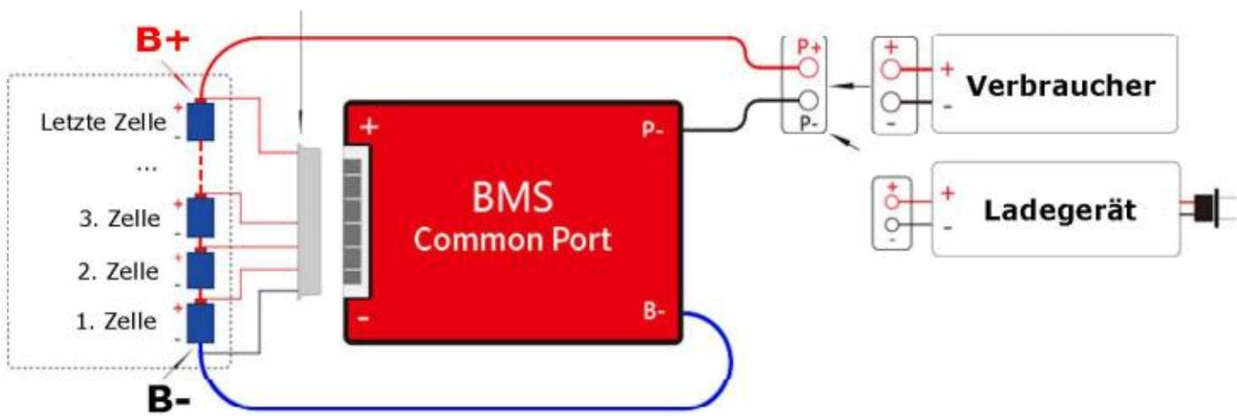
Der Balancer Stecker DARF NICHT ins BMS eingesteckt sein, wenn die Balancer Kabel angeschlossen oder sonst wie bearbeitet werden!!!
