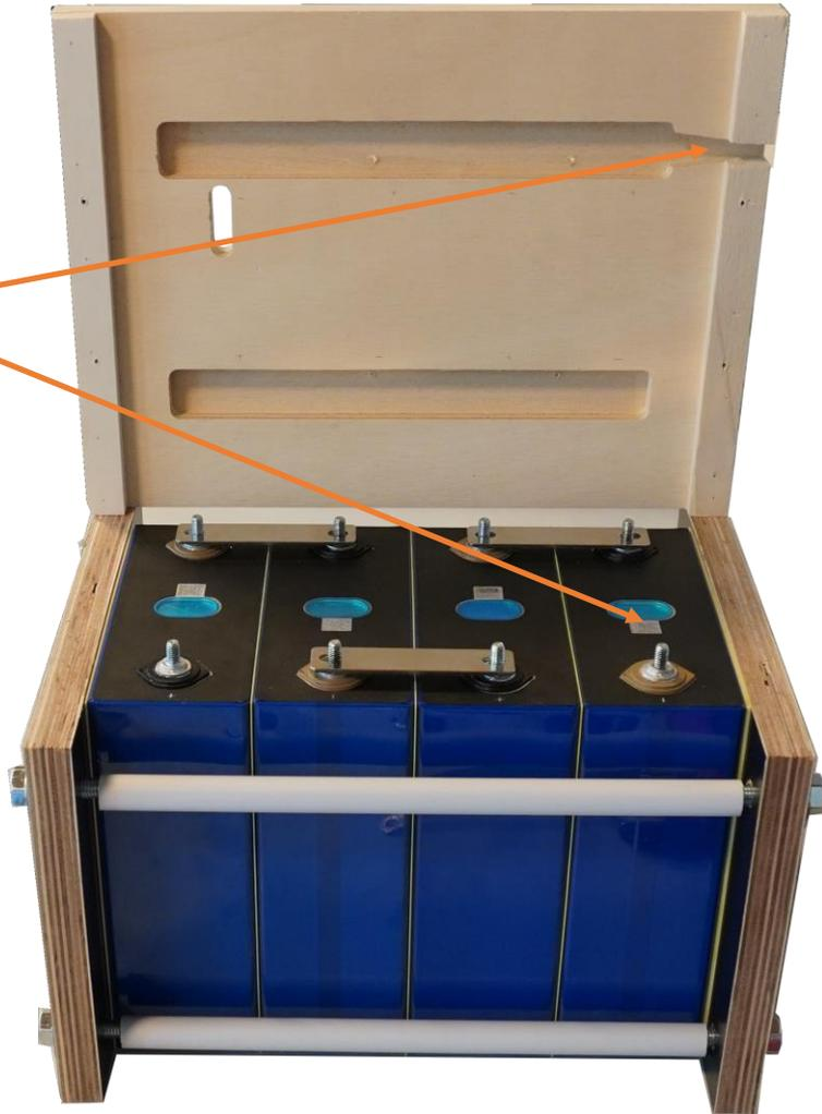
**2.** Dann den B- vom BMS auf den – Pol bei der Batterie anschließen und das BMS runterhängen lassen. Beachte am besten schließt du den Pluspol direkt an den Wechselrichter oder deine Stromschiene an. Du kannst das auch später machen bevor du die Abdeckung festschraubst.
